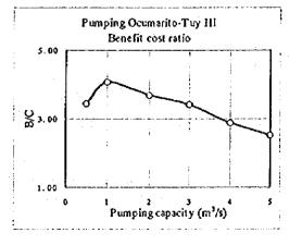
El (B-C) tiene el mas alto valor con la capacidad de bombeo de 4 m³/s. Mientras que (B/C) toma el valor mas alto con una capacidad de bombeo de m³/s. Los valores de B/C son altos en todos los casos en mas que 3. Los valores de B-C para la capacidad de bombeo de 3, 4 y 5 son casi iguales. De acuerdo a esto es recomendable la capacidad de bombeo de 5 m³/s.
