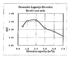
Como se ilustra arriba, ambos B-C y B/C son maximos con la capacidad de desvio de 2 m³/s. La capacidad de desvio ha sido determinado en 2 m³/s considerando el valor mas alto de B-C y B/C. El costo de la construccion es estimado en US\$19.44 millones.
