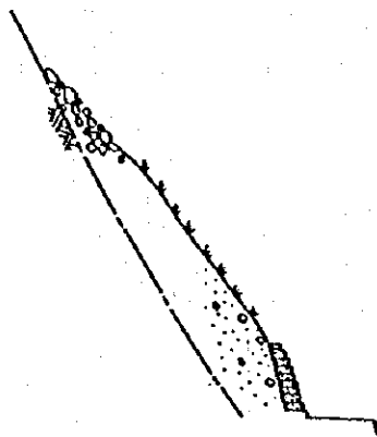
図2.9 崖すい斜面を切土する場合の対応
