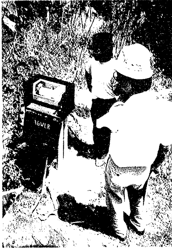
地すべり地の地下水位計
