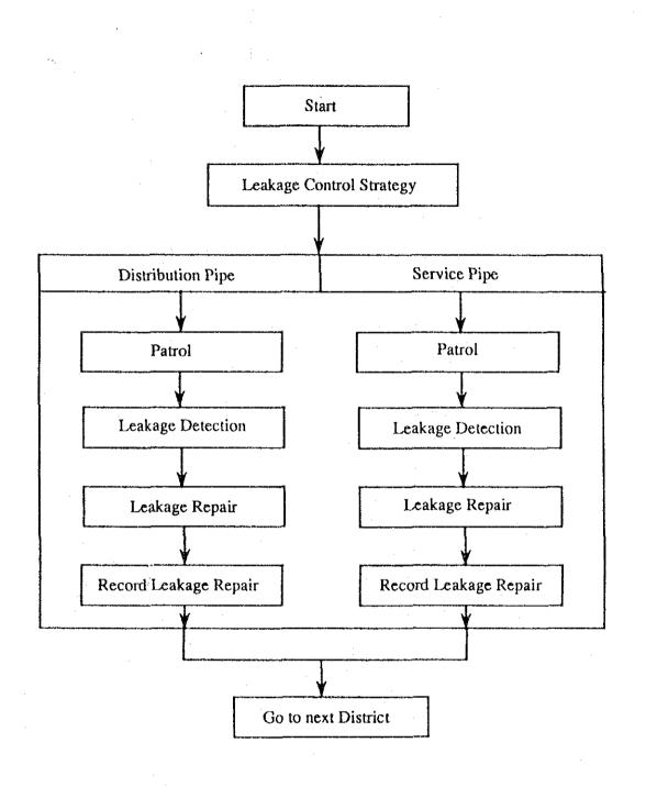
PROCEDURE OF ABOVE -GRAND LEAKAGE CONTROL
