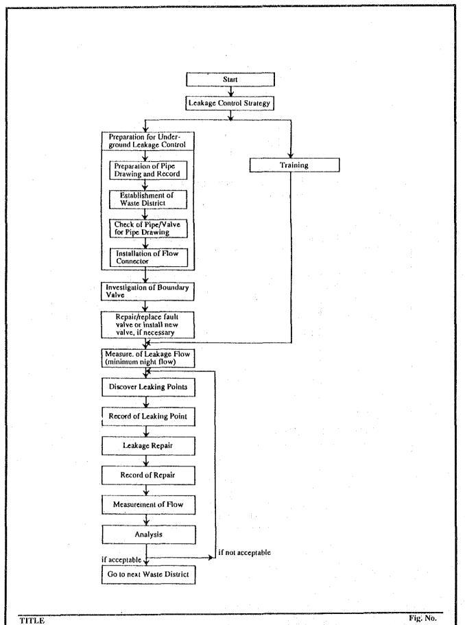
PROCEDURE OF UNDERGROUND LEAKAGE CONTROL
