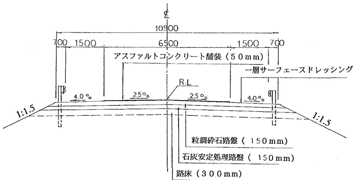
図5.4 取付道路断面図
