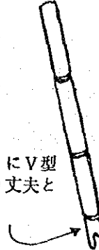
図Aは木の枝や竹で杖型植付機を製作する一例を示す
