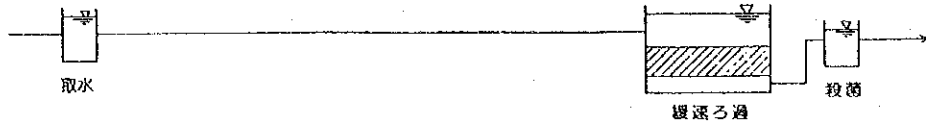
(a) 年間を通じて原水が清澄であり、最高濁度でも10度位の場合
