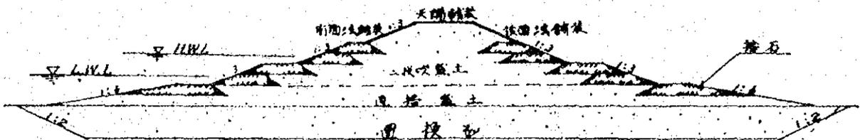
この図-1、図-2の堤防断面形の工事の種類は、おおむね次のとおり分類できる。
