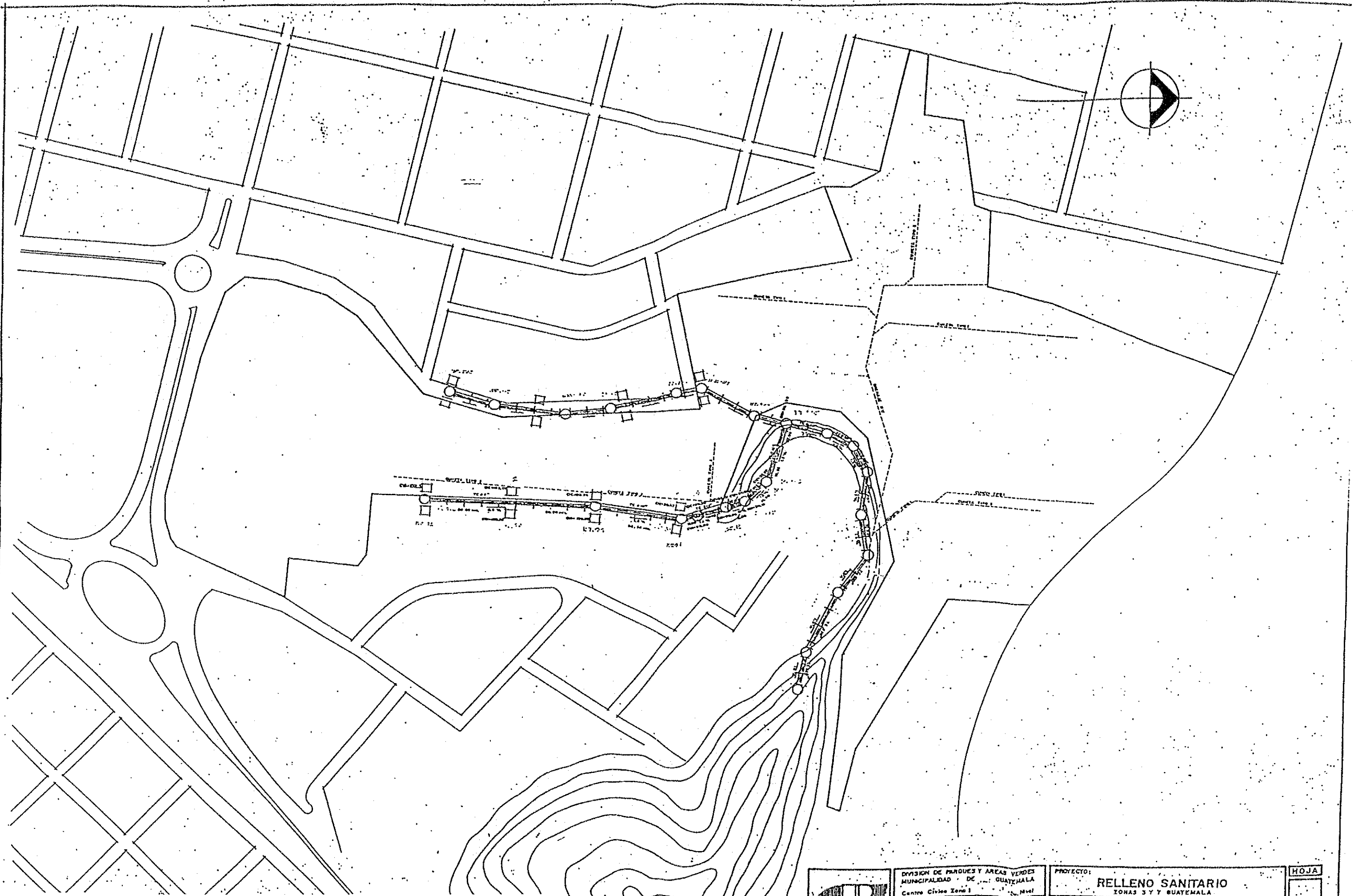
FIGURA 6 PLANO DE DRENAJES EN EL RELLENO SANITARIO
