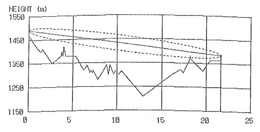
SITE NAME : Gutu Rep. SITE NAME : Soti Sour GROUND LEVEL : 1470.0 m GROUND LEVEL : 1363.0 m ANT.HEIGHT 1 : 20.0 m ANT.HEIGHT 2 : 20.0 m
