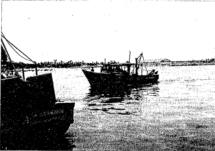
〔ミニトロール船〕 全長10m 前後のトロール 漁船，乗員は5～6名。
