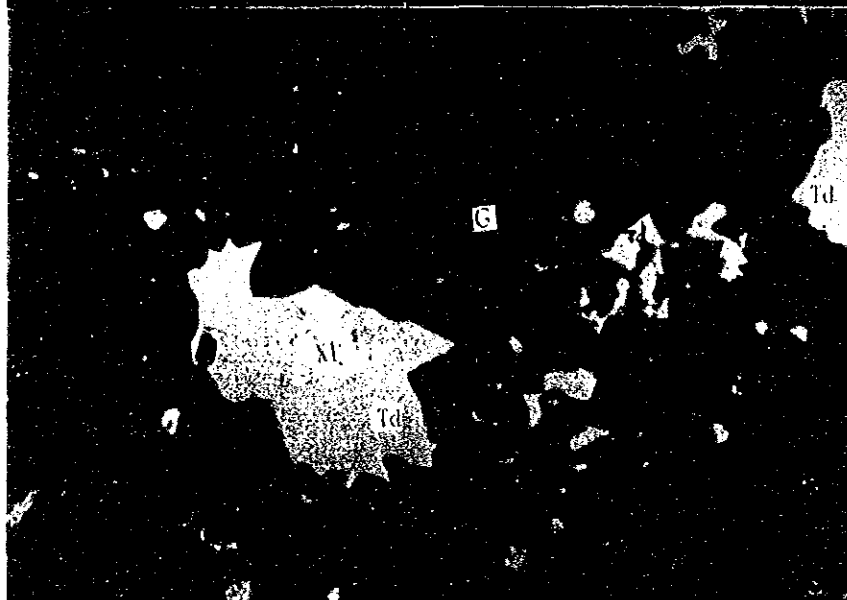
含銀四面銅鉱(5 μm ~ 40 μm) と共存するAg-Cu-S鉱物?(X1, 10 μm)
