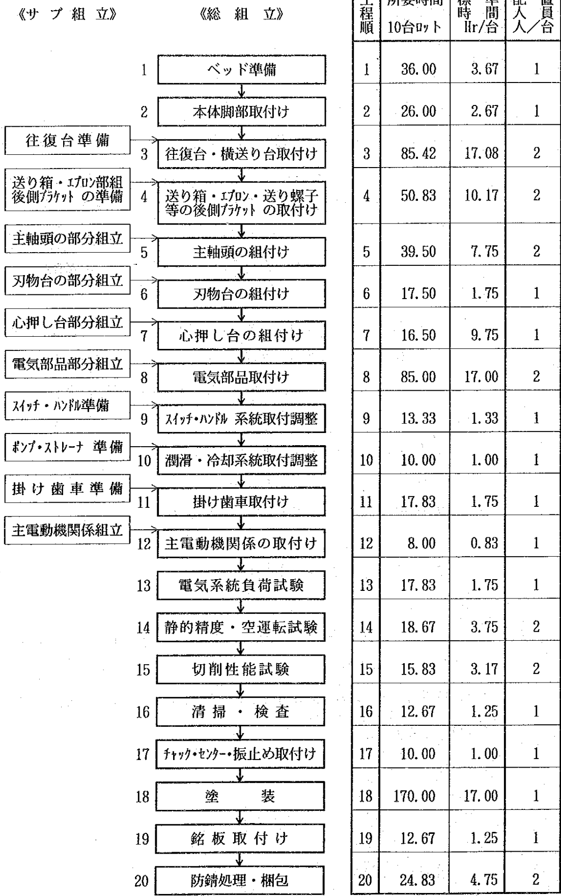
図 II - 94 旋盤CA6140 組立工程図
