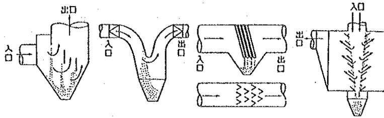
(a) 衝突式 (b) 反転式 (c) 多列衝突式 (d) ルーバ式
