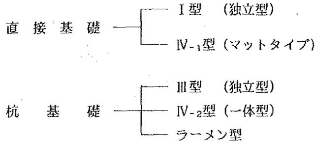
今回の設計では、基礎型比較検討の結果、直接基礎ではI型、杭基礎ではIII型を採用した。
