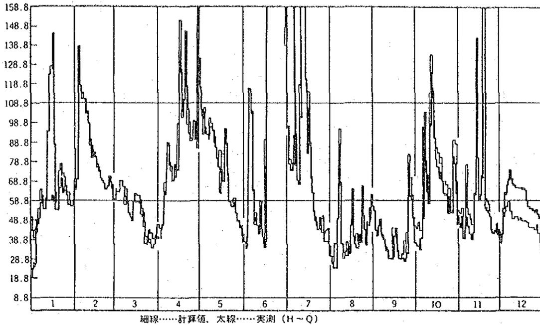
図-27 水循環モデルの検証例（筑後川流域、本川下流端流量 昭和50年）
