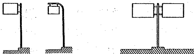
FIGURA 4-10-9 FORMA DE INSTALACION DE LAS SEÑALIZACIONES VERTICALES
