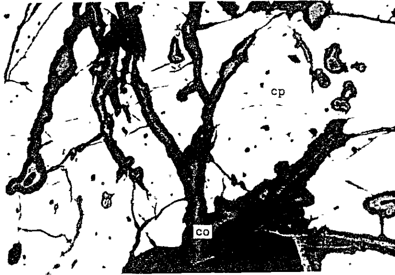
Nº de Muestra: FL-5 Mineral : Cu-Pb Nicol : Abierto cp: calcopirita, co: covelina
