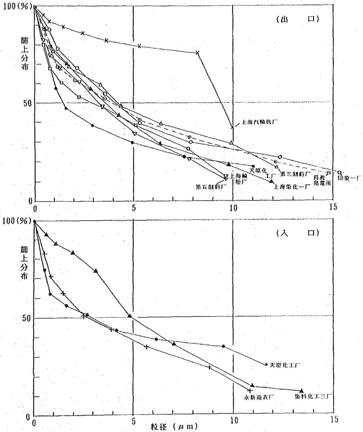
図 1.1 - 1 工業用Boilerの集塵装置の入口及び出口煤塵の粒径分布
