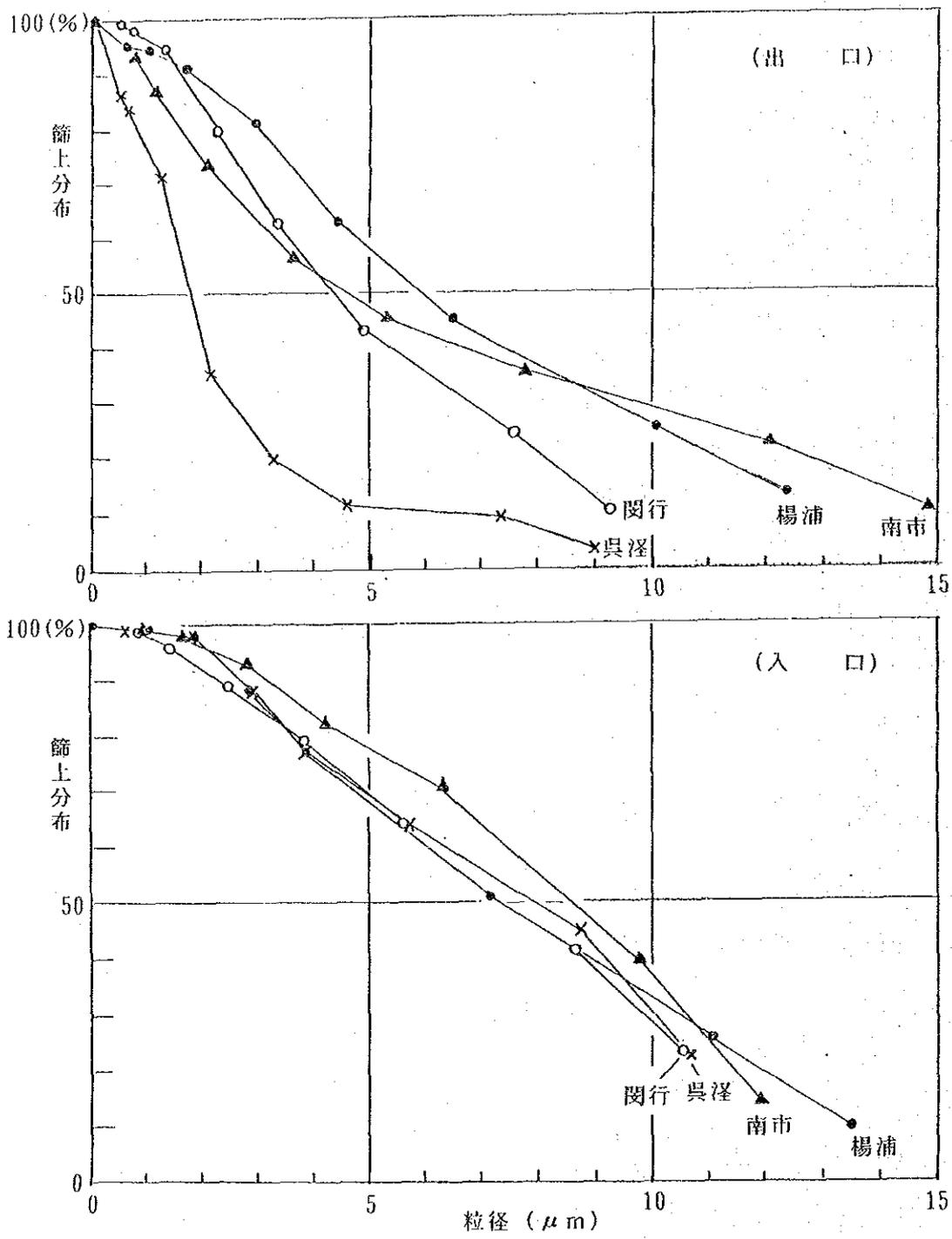
図 1.1 - 2 発電所Boilerの集塵装置の入口及び出口煤塵の粒径分布
