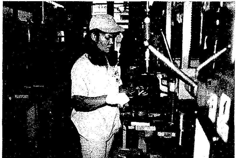
オルタネーターの組付け
