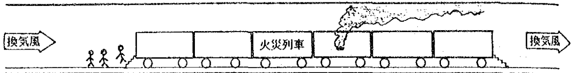
図 3-6-31 PUSH-PULL 排煙方式
