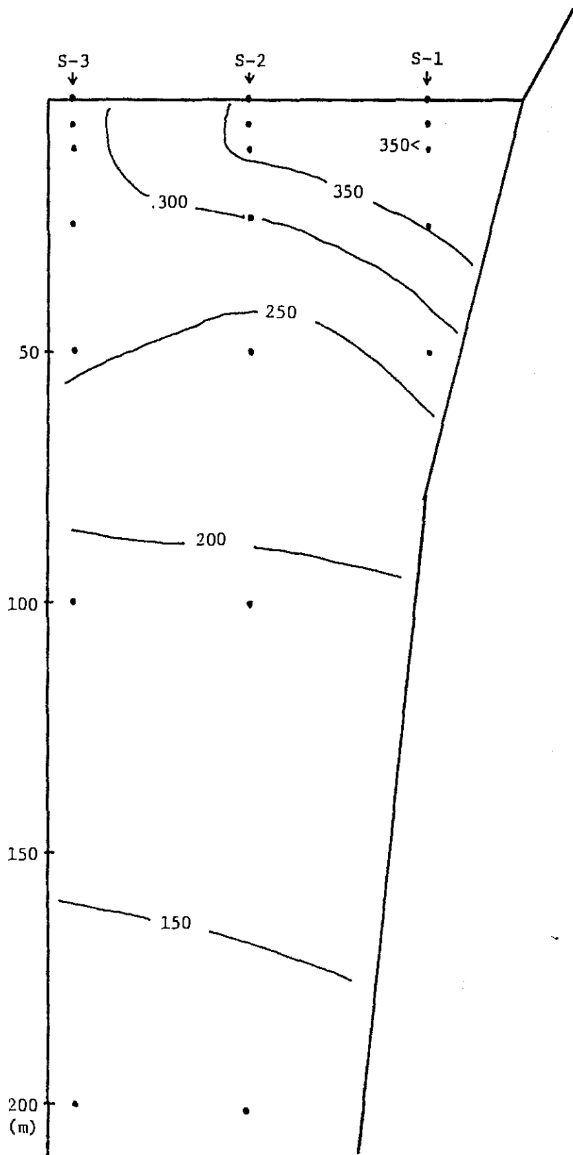
Fig. 14, Distribución vertical de anomalía sobre perfil de la Linea S (Lat. sur 46°00)
