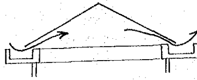
図3-7 屋根スラブなし勾配屋根の例
