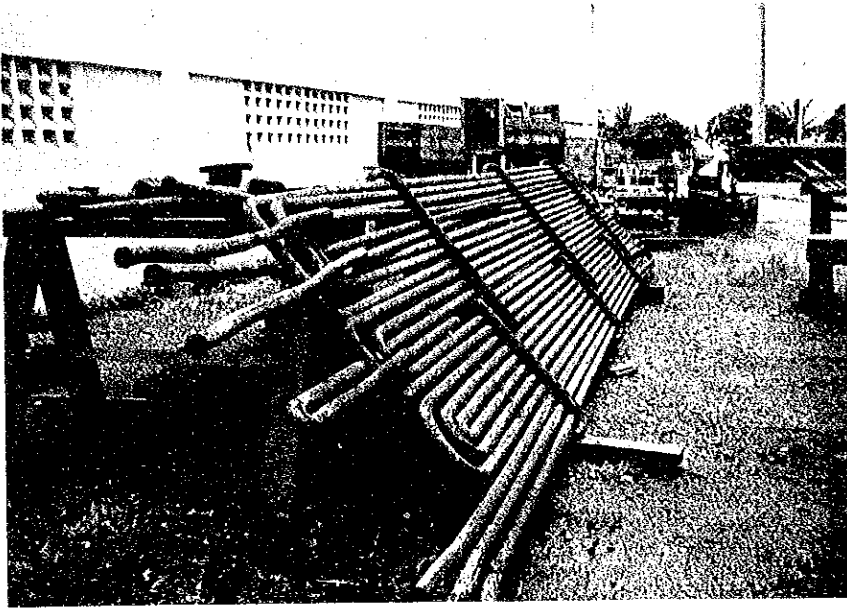
G-2 : 2次過熱器チューブ 最近のオーバーホールで取外されたもの
