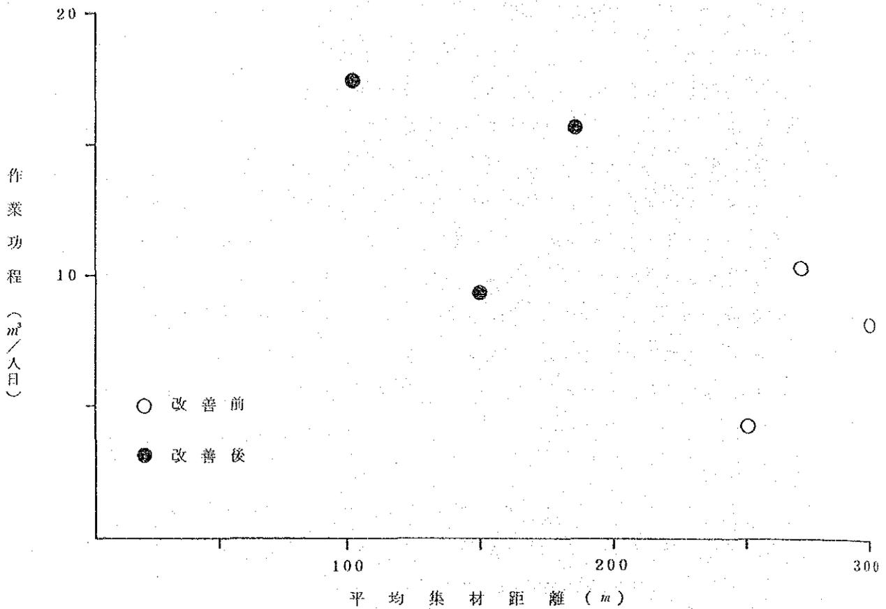
図 20 トラクタ集材における集材距離と作業功程
