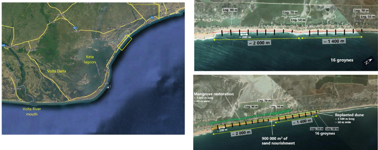
図 4-12 Dzita – Anloga area (Blekusu) 左：位置図、対策例：右上 1 突堤のみ、右下 2 突堤＋養浜
