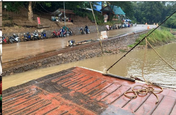
④ メコン川の水位によってスロープの接岸位置を調節可能
