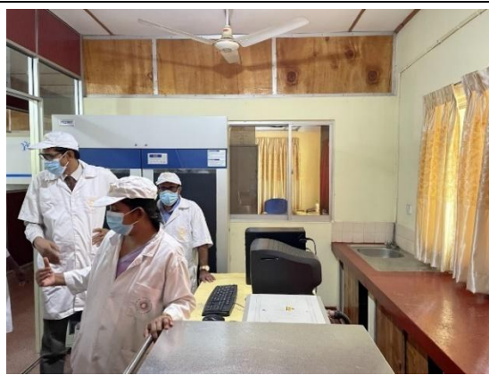
CAIS の精子凍結室／手前の金属製の箱が精液ストローを凍結させるための冷凍機、液体窒素タンクと連結されている
