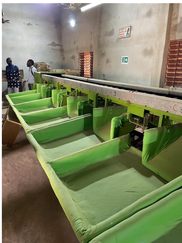
Figure 8.3.4 Trieuse de station de conditionnement
