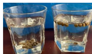
浮上性と水中での保形 左 (キャッサバ) は浮上せず、右 (CMC) は溶けることなく 10 時間以上浮上した。
