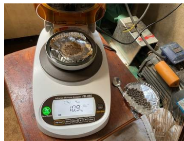
赤外線水分計により乾燥前と乾燥後の水分を計測
