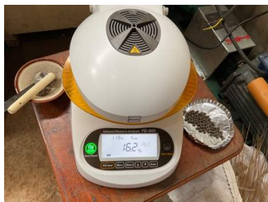
赤外線水分計により乾燥前と乾燥後の水分を計測
