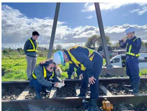
道床横抵抗力の測定の様子
