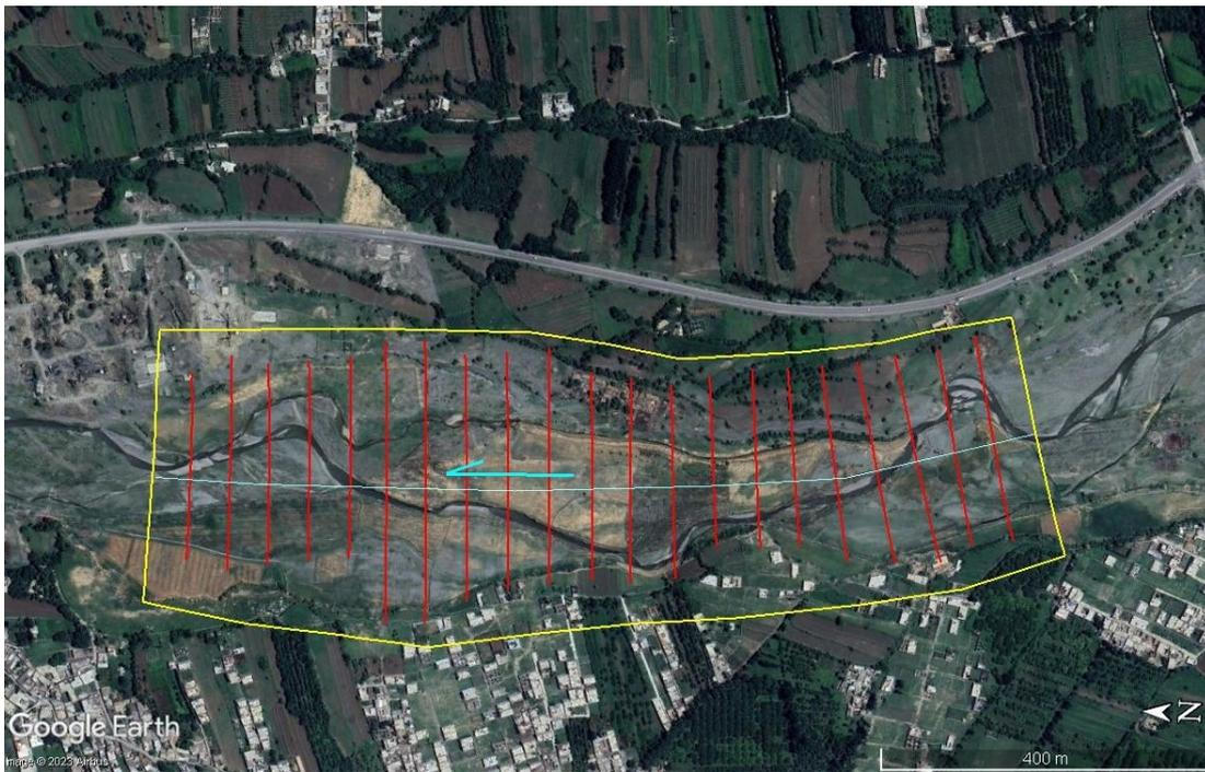
■ : 地形測量の範囲    — : 縦断測量位置    — : 横断測量位置
