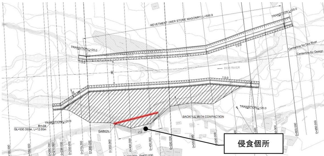
図 6.2.57 高水護岸の平面配置図 (Sikandarpur)
