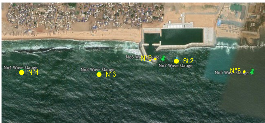
Figure 5-4 Emplacement d'installation des manomètres pression eau pour une mesure simple de la hauteur des vagues (N°3, N°4, N°5, N°6)
