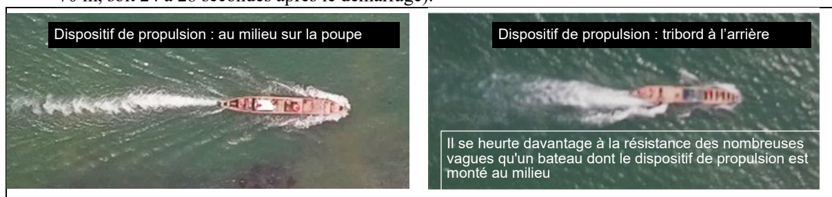
Figure 6-14 Différence de méthode de fixation du dispositif de propulsion et résistance des vagues
