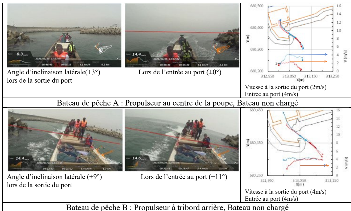
Figure 6-16 Comparaison de l'angle d'inclinaison latérale et de la stabilité lors de l'entrée et de la sortie du port
