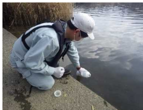
写真 4-1 直接採水の様子
