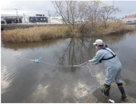
写真 4-2 バケツ採水の様子
