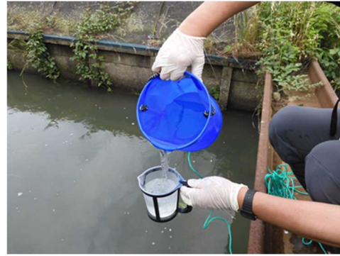
写真 4-2 バケツ採水の様子
