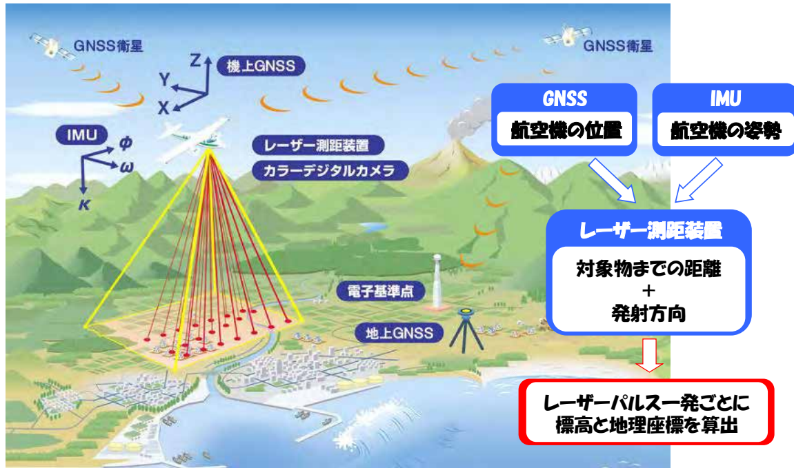
図 5-1 航空レーザの計測イメージ
