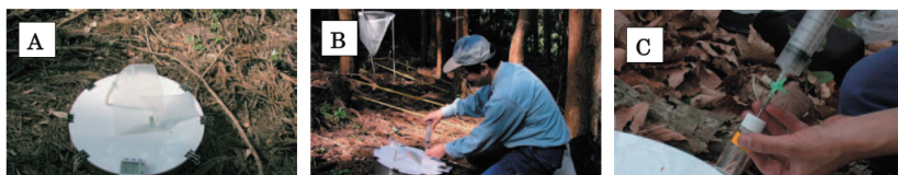
図 T02-2 フラックス法による温室効果ガスの計測 5)
