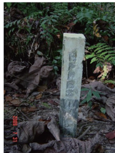
図 T13-2 攪乱への耐性がある杭の事例 (コンクリート製)
