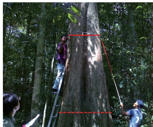
図 T13-5 板根の発達した個体での直径計測 点線で示した部分が高さ 1.3m であるが、この位置で計測するのではなく、板根の影響がなくなった実線の位置で計測する必要がある
