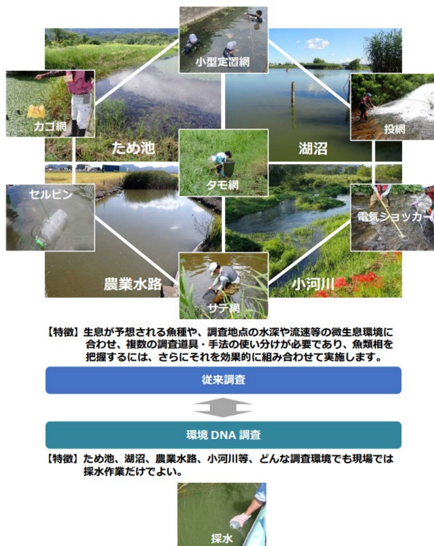
図 2-7 環境 DNA 調査と従来調査の特徴(淡水魚類調査の例)
