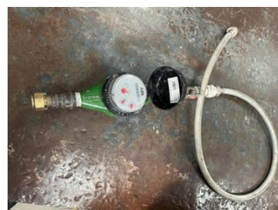
出所：調査団撮影(2024 年 11 月) 顧客の水道メータの 検査用メータ
