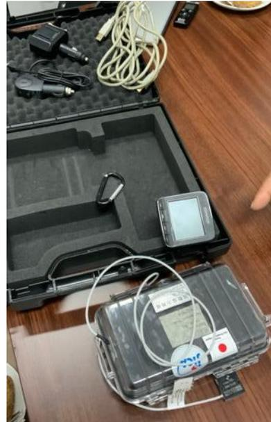
写真4 道路維持管理コンポーネントで供与された移動路面モニタリングシステム（DRIMS）。BARMM公共事業省が路面のラフネス測定に使用。状態は良好で、持ち運びもしやすい。
