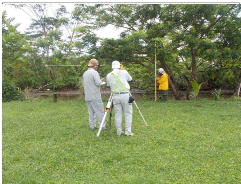
横断測量状況
