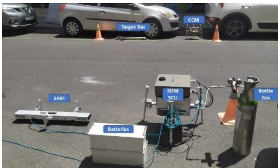
Зураг 6. Хэмжих хэрэгслийг суурилуулах жишээ (SAM, SAM-д зориулсан зорилтот бар, CCM, шалгалт тохируулгын хий)
