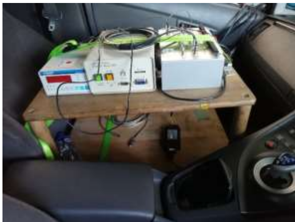
Зураг 1: Хэмжигч багаж суурилуулсан байдал ( зүүн гар тал : Тээврийн хэрэгслийн кабинд суурилуулах хэмжигч багажууд. Баруун гар тал : NOx мэдрэгч )
