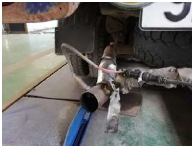
Зураг 1: Хэмжигч багаж суурилуусан байдал (зүүн гар тал : Тээврийн хэрэгслийн кабинд суурилуулах хэмжигч багажууд. Баруун гар тал : NOx мэдрэгч, PM хэмжигч хоолой)
