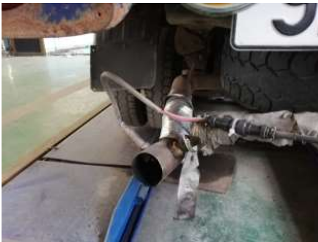
Зураг 1: Хэмжигч багаж суурилуусан байдал (зүүн гар тал : Тээврийн хэрэгслийн кабинд суурилуулах хэмжигч багажууд. Баруун гар тал : NOx мэдрэгч, PM хэмжигч хоолой)
