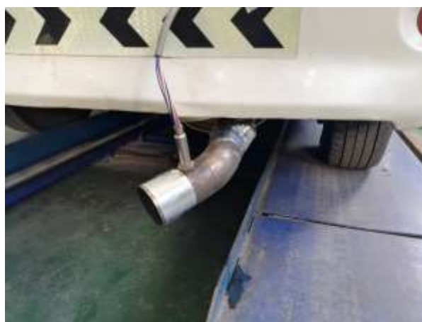
Зураг 1: Хэмжигч багаж суурилуулсан байдал ( зүүн гар тал : Тээврийн хэрэгслийн кабинд суурилуулах хэмжигч багажууд. Баруун гар тал : NOx мэдрэгч )
