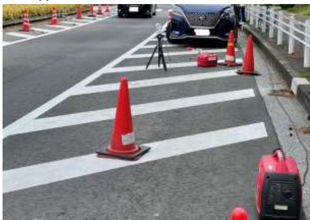
Зураг 2. Хэмжих төхөөрөмжийг суурилуулах жишээ (генератор)
