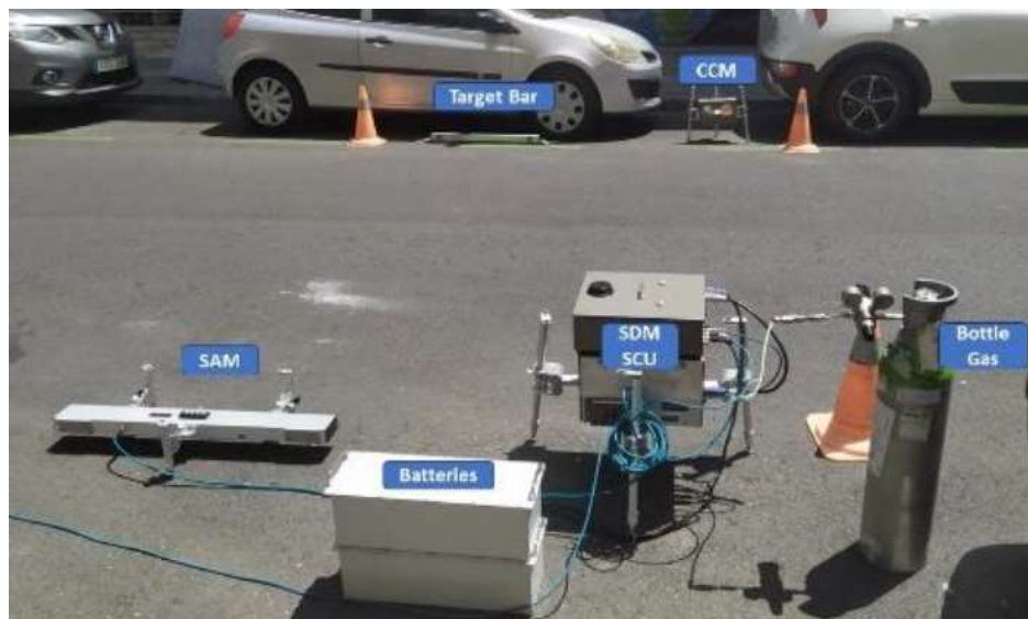
図 6. 測定器設置例（SAM、SAM 用ターゲットバー、CCM、校正ガス）
