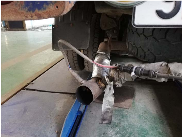
図1 計測装置（左：車内計測器、右：NO x センサー、PM 導入管）
