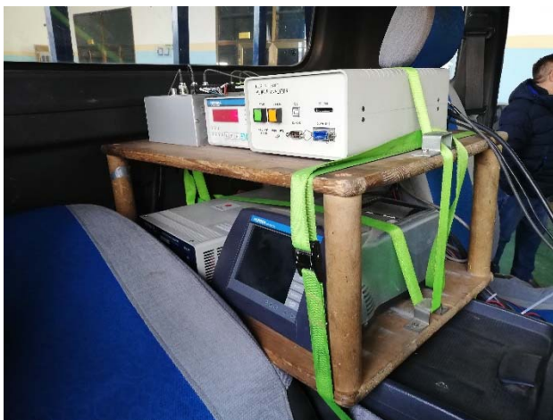
図1 計測装置（左：車内計測器、右：NO x センサー、PM 導入管）
