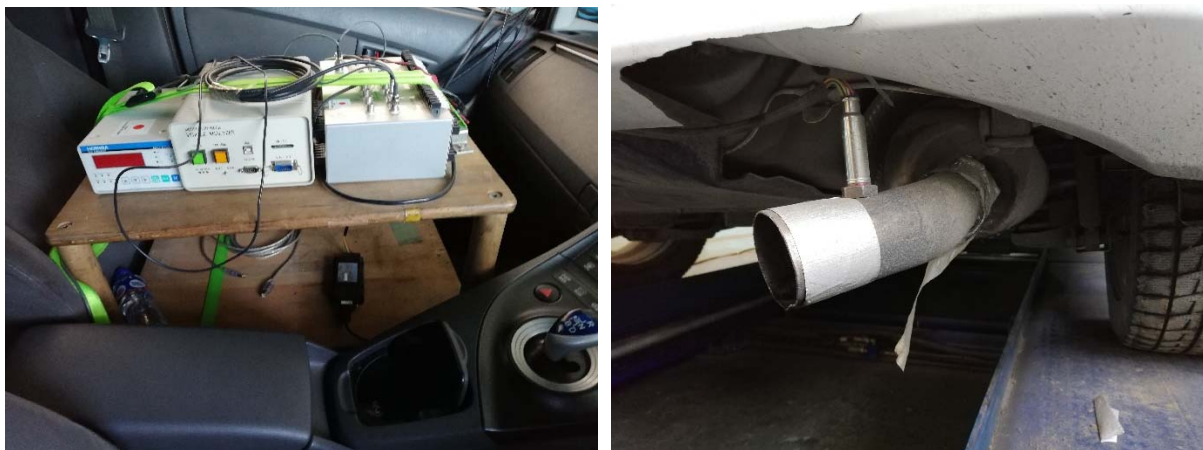
図1 計測装置（左：車内計測器、右：NO x センサー）
