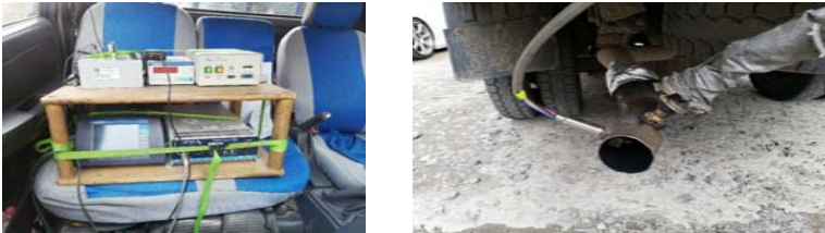
図 6 車載型排ガス計設置状況
