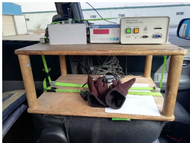
図1 計測装置（左：車内計測器、右：NO x センサー）
