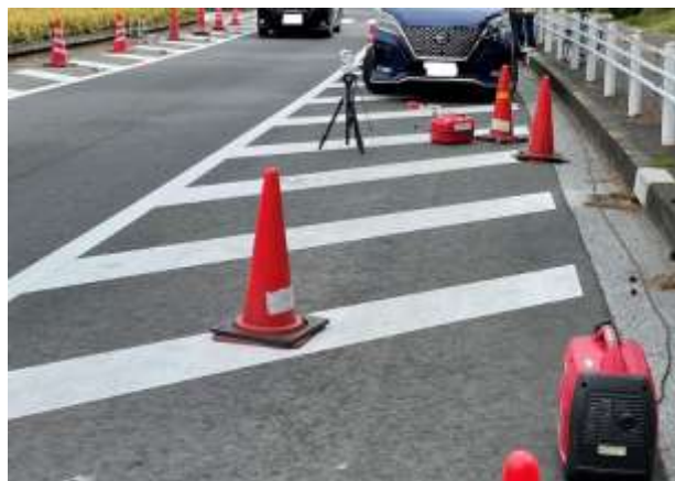
図 2. 計測機器設置例（発電機）
