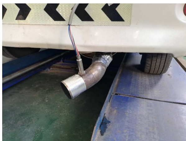
図1 計測装置（左：車内計測器、右：NO x センサー）
