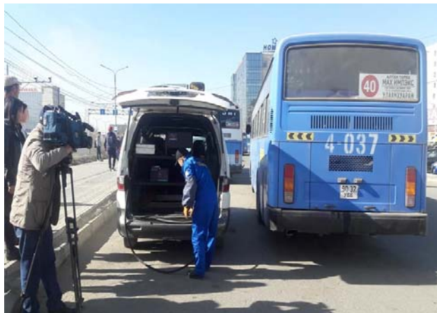
Зураг 16. ЗГА-ай хамтран тээврийн хэрэгсэлийн яндангаас гарах хорт хийн утааг хэмжих хяналт шалгалт хийж байгаа нь.
