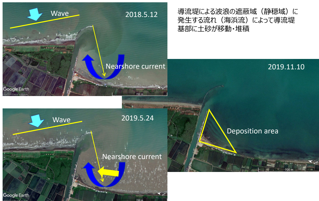
図 84 構造物 A Indramayu 火力発電所防波堤周辺の地形変化
