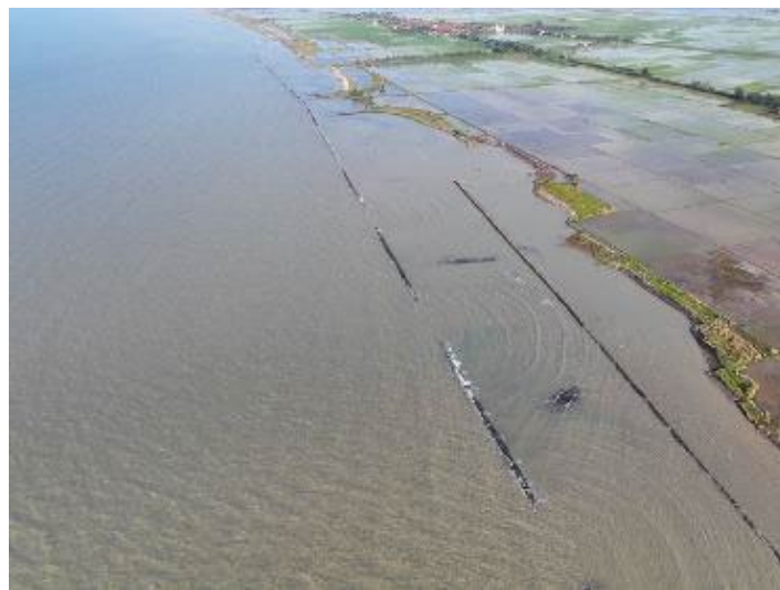
図 61 離岸堤と回折波 (離岸堤背後にさらにブロックらしき施設あり)
