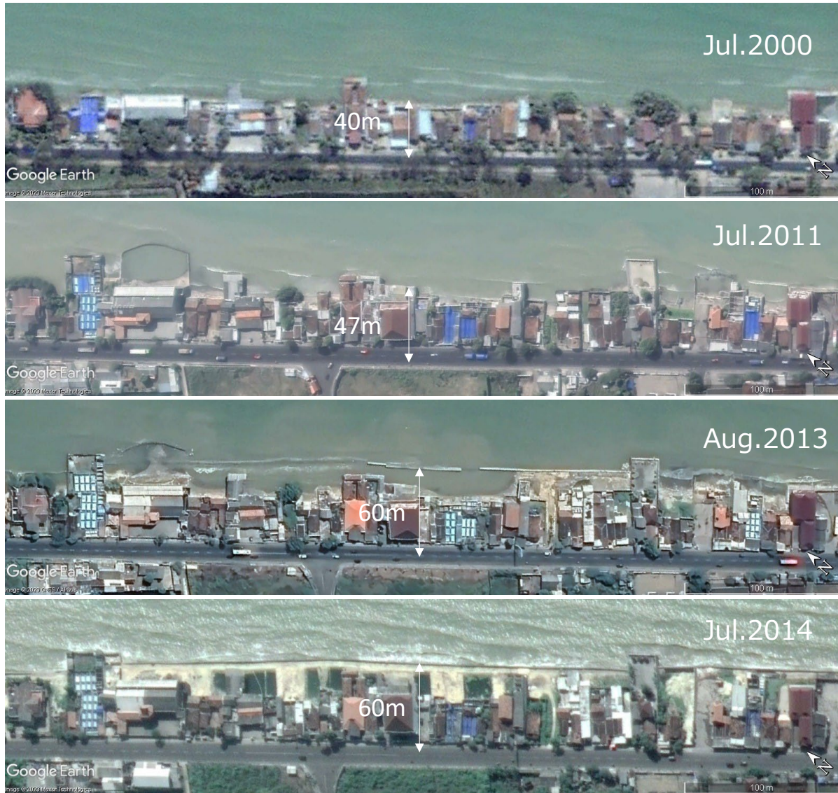
図 89 埋立地南側海浜での離岸堤周辺の地形変化(地点 B)
