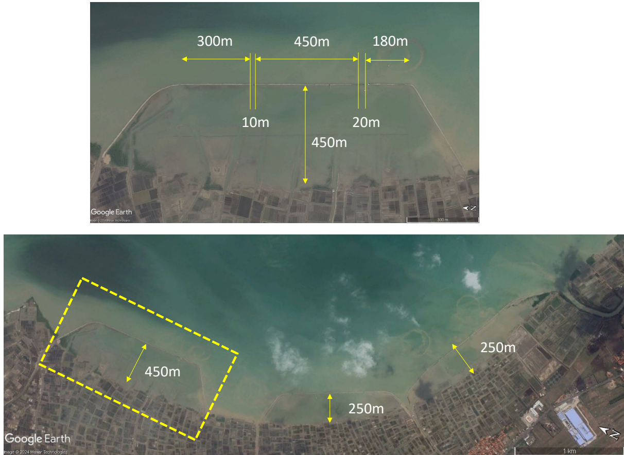
図 93 沖合消波施設の平面配置例(Cirebon)
