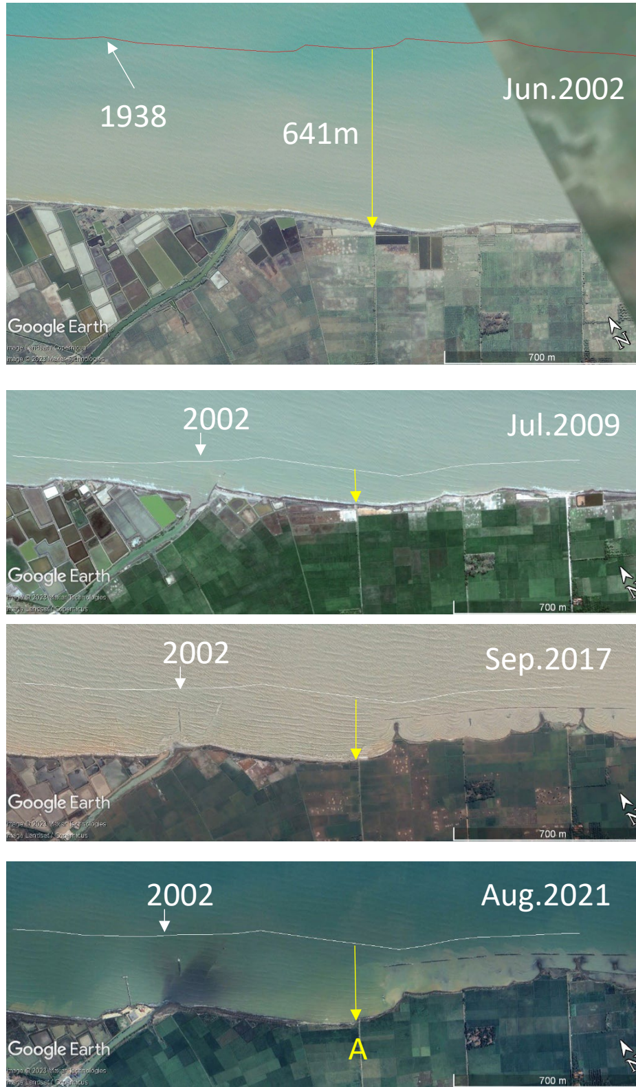
図 40 Indramayu East 離岸堤周辺の地形変化
