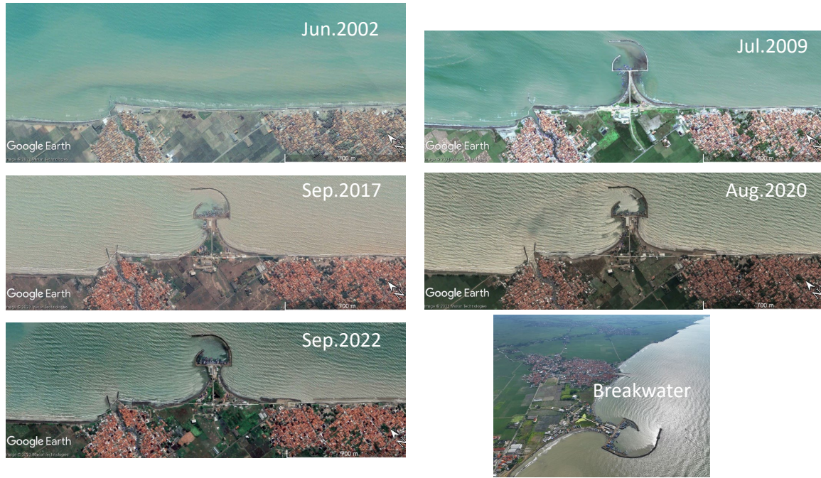
図 86 構造物 C Indramayu East 漁港防波堤周辺の地形変化の変遷
