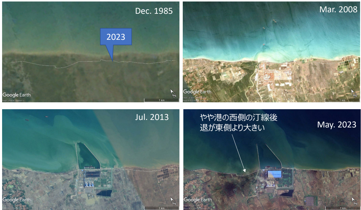
図 84 構造物 A Indramayu 火力発電所防波堤周辺の地形変化
