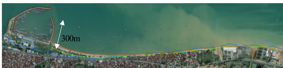
図 107 海岸施設によって捕捉されて生じた汀線変化 (Rembang) (2)
