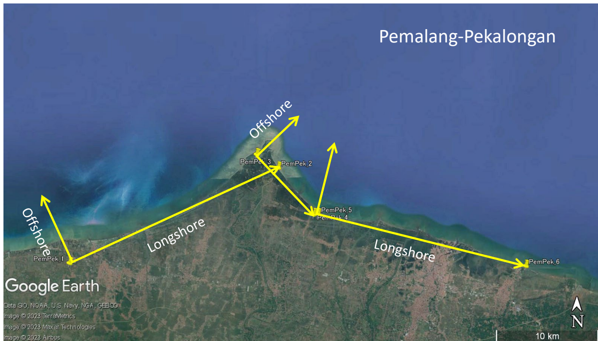
図 64 汀線位置読み取り軸位置 (Pemalang-Pekalongan)
