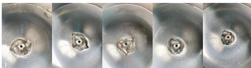
図 2-26 実験に使用した提案製品 (ECBL-5N) の実験終了後における各ノズルの内部構造 出典：提案法人作成
