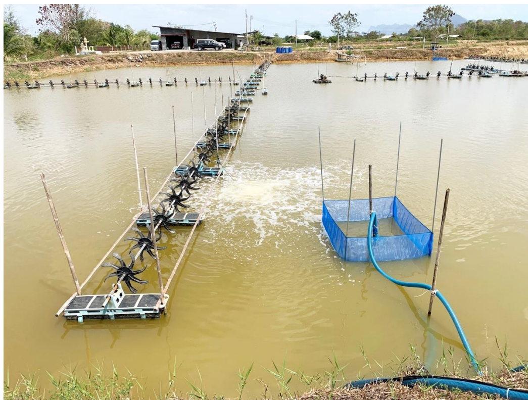
図 2-9 実験池で提案製品（ECBL-5N）から発生するマイクロバブル 各ノズルから 10.5 L/min.のマイクロバブルが発生 出典：提案法人作成
