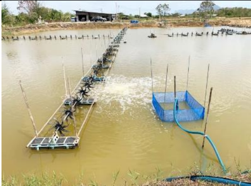
実験池で提案製品から発生するマイクロバブル
