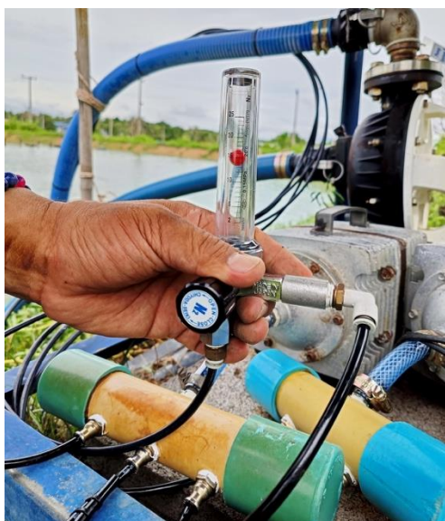
図 2-1 7 提案製品（ECBL-5N）の各ノズルへの通気量の測定（約 15 L/分） 出典：提案法人作成
