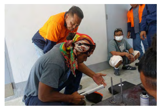
8-カラーチェックを用いた部品検査
