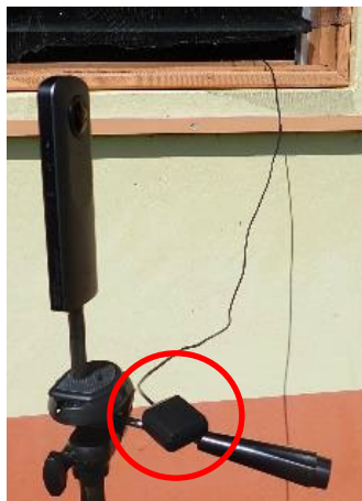
図 3.3.2. 携帯（可搬）型地震計及び PC（左赤丸は携帯（可搬）型地震計に付随する GPS 受信機）
