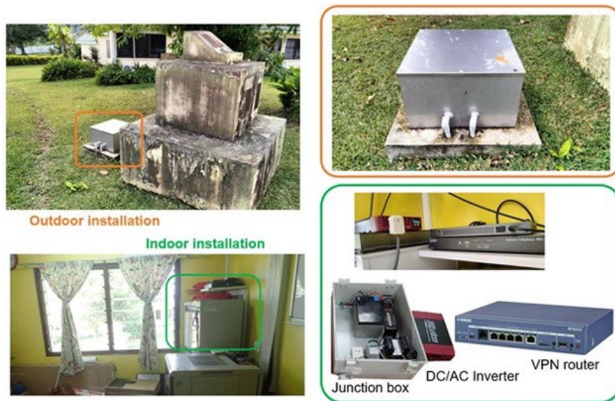
図 3.2.13(b). シェファプロビンスオフィス への震度計の実際の設置
