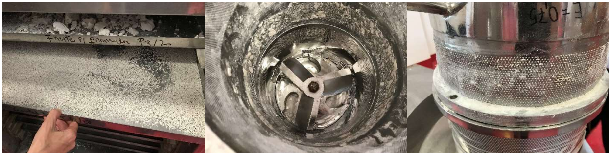
ケムテック社所有の顆粒製造機(円筒式造粒機)
