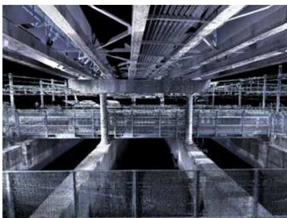
図 3.2.7 3次元点群データからの図面作成イメージ
